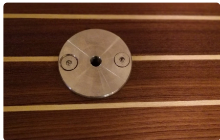
Alt av. Igjen blir festepunktene, 5 mm høye og uten skarpe kanter.
